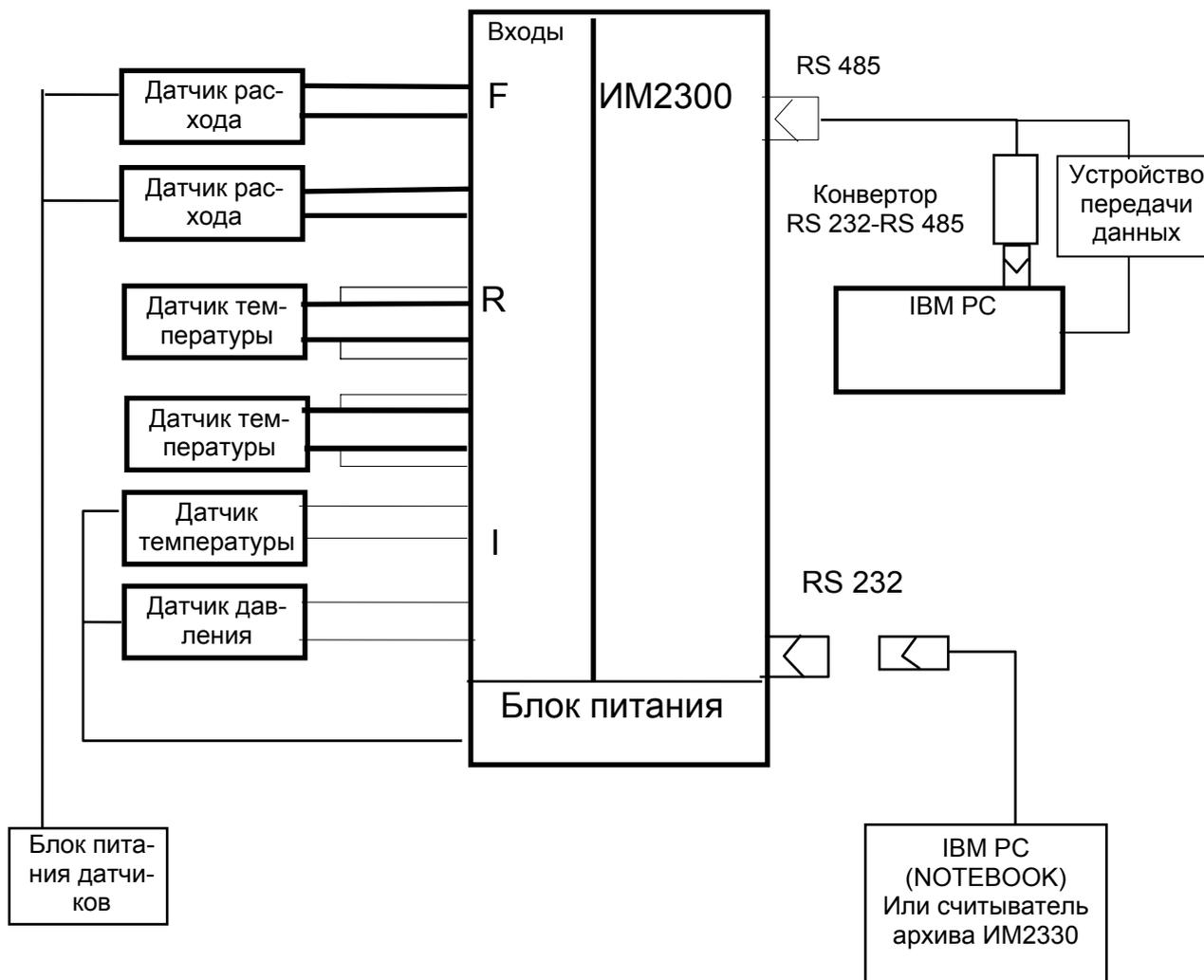
Примечание: Количество датчиков расхода, температуры и давления может быть изменено в зависимости от конкретной модификации теплосчетчика
